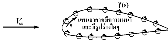
รูป 4.11 การจำลองการไหลผ่านแผนอากาศโดยการกระจายวอร์เทคไปตามผิวแผนอากาศ
