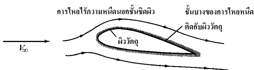
รูป 1.19 ย่านการไหลในชั้นขีดผิวและการไหลไร้ความหนืดนอกชั้นขีดผิว
